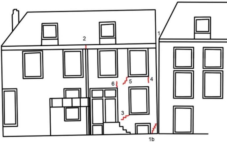
Figure 10.15 Cracks side façade (Vijzelgracht 4 on the left, 1e Weteringdwarsstraat 70 on the right)
